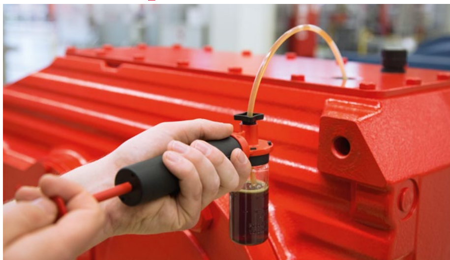
Probenahme aus einem SEW-EURODRIVE Großgetriebe. OELCHECK-Ölanalysen passen perfekt zum Condition-Monitoring-Service von SEW-EURODRIVE.
